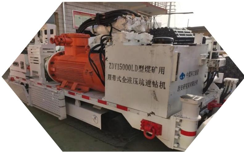
西铭矿新近引进的“千米钻机”——ZDY15000LD型煤矿用履带式全液压坑道钻机日前在抽采一队投入使用,助力该矿瓦斯抽采工作提档升级。
