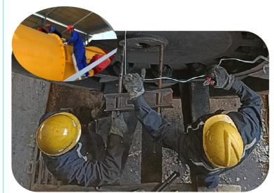
官地矿安家沟风机承担 着井下中六区的供风工作。 为避免主扇电机轴承温度过 高,保障风机安全运行,日前, 该矿组织人员对主扇电机轴 承进行了更换。
