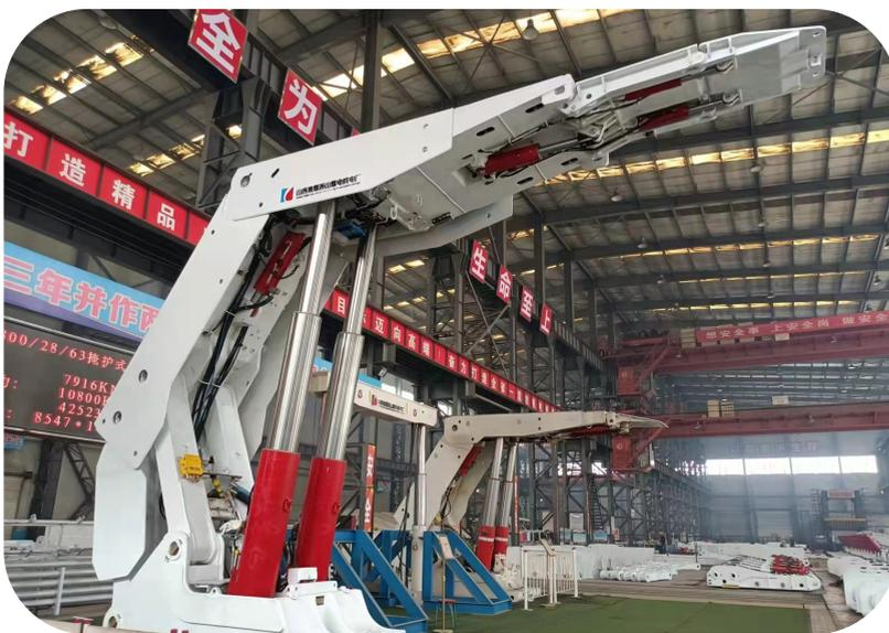
近日,机电厂 ZY10800 液压支架完成样机试制。这是该厂继 ZF21000/28/42D 型放顶煤液
