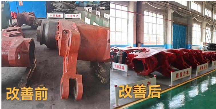
机电厂机修车间以往采煤机摇臂各种机型未区分存放,当遇矿方急需部件时,无规则的摆放需要至少两人配合吊车来回吊运才能吊出所需要的部件完成装车,费时又费力。
