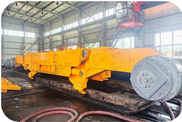
日前,镇城底矿新引进MG500/1140-GWD型采煤机前期组装工作基本完成,由于新型采煤机需使用3300V级电压,在该矿属于首次使用,为保证设备安全安装与运行,该矿组织人员进行调试、试运转,并开展实操培训,邀请厂家技术人员对安全操作技术要领作了详细讲解及技术指导,促新设备入井后正常安装使用。
