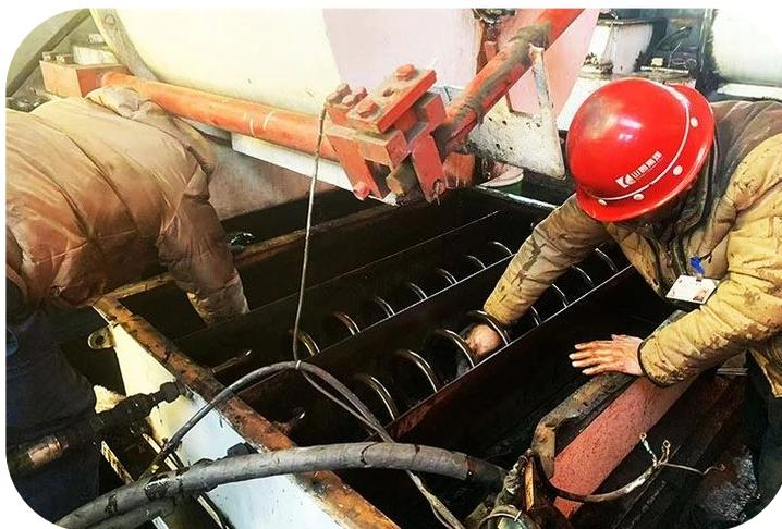
1月3日,镇城底矿选煤厂压滤车间更换卧式离心机差速器油。
