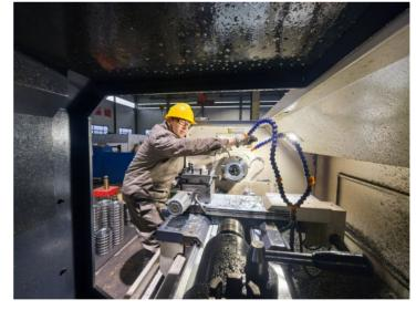
新年伊始,为充分 保证矿井安全生产所 需,连日来,杜儿坪矿多 种经营公司机电设备厂 职工加班加点对滚筒 轴、矿车轮等井下急需 的零部件进行加工,努 力为井下矿车安全运行 提供保障
