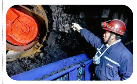
1月10日, 两铭 矿采煤机司机在进 行开机前检查工作, 逐项安全确认,确保 设备正常运转,奋力 冲刺"首季开门 红"。
