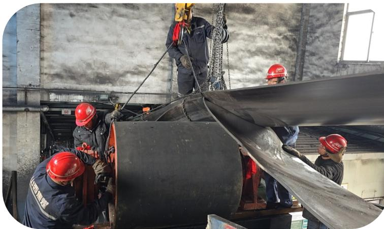
近日,杜儿坪矿排矸公司在日常隐患排查中发现滚筒磨损严重,皮带出现跑偏,存在安全隐患。为确保生产安全,干部职工立即行动,加班加点进行设备抢修。经过连续七小时的更换作业和两个小时的精细调试,设备恢复了正常运行。
