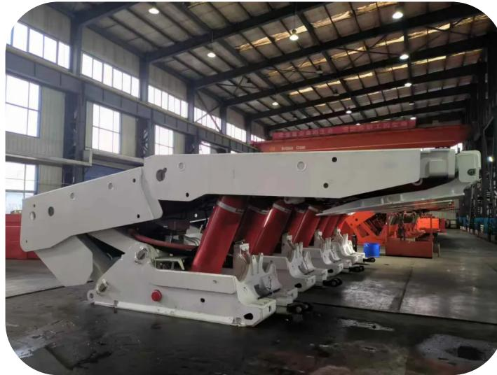
近日,机电商支架修理车间首台自主组装的大采高ZY11000/25/50D型液压支架圆满完成组装,顺利通过三级验收,标志着机电商液压支架技术装备水平实现突破性提升。
